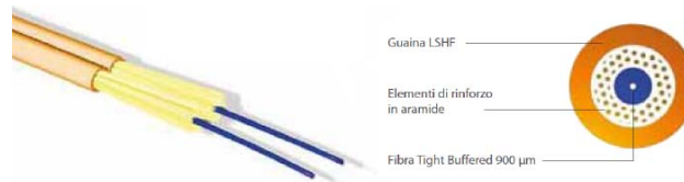
Cavo in fibra ottica di tipo tight
