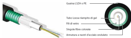
Cavo in fibra ottica armato da esterno
