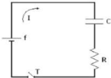
Resistenza  $R = 10 \Omega$ , capacità  $C = 2 \mu\text{F}$ .
