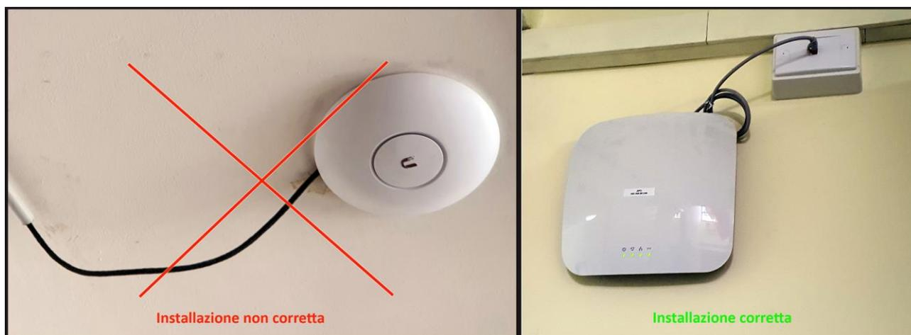
Figura 10 – Installazione corretta dell'Access Point
