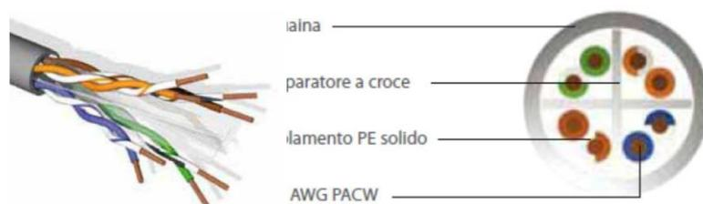
Qualora l'installatore ha problematiche di cablaggio in canalizzazione promiscua con cavi elettrici a 220V, allora dovrà utilizzare cablaggio opportuno
