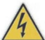
Tensione elettrica pericolosa
