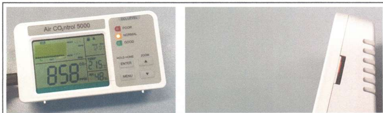
Fig. 5. Fasi del collaudo: AirCO 2 ntrol 5000. Su un lato lo strumento contiene una Sd-Card che memorizza i dati di misura.
