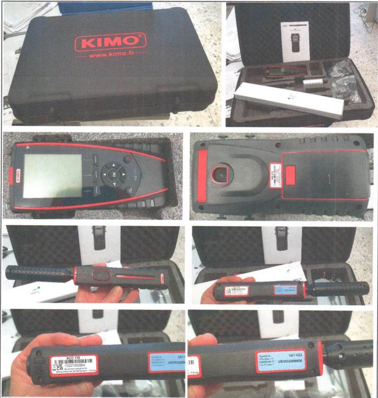
Fig. 4. Kit analizzatore multifunzione HQ 210 + sonda SCO 110 per analisi CO.
