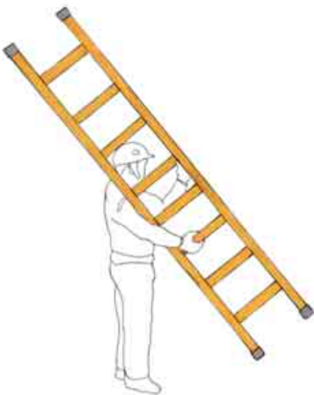
Fig. 23 - Modalità corretta di trasporto della scala a spalla
