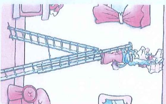
Le scale doppie sono quelle composte da due tronchi che appoggiano a terra e vanno bene quando si sta al centro di una stanza o si devono fare lavori con le braccia sollevate sopra la testa.
