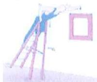
Onde evitare il ribaltamento della scala pieghevole, è necessario mantenere il proprio baricentro più all'interno possibile, senza sbilanciarsi verso l'esterno.
