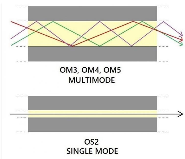
Le fibre multimodali ottimizzate per l'utilizzo con laser da 50/125  $\mu\text{m}$  (OM3 e OM4) sono state tradizionalmente raccomandate per le dorsali di edificio per 10 Gb/s fino a 300 m (OM3) e 550 m (OM4) sulla base del minor costo globale del sistema se confrontato con la soluzione monomodale (fibra e transceiver ottici). La fibra monomodale è tipicamente installata dove le lunghezze di
