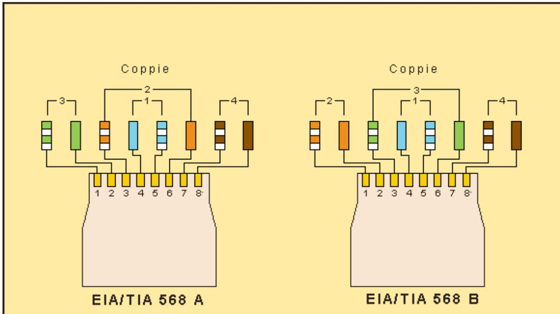
Figura 7 - Plug RJ45. I due metodi di crimpaggio sono equivalenti ma non possono coesistere in uno stesso impianto ambedue i sistemi. O si utilizza la connessione di tipo A o di tipo B.
