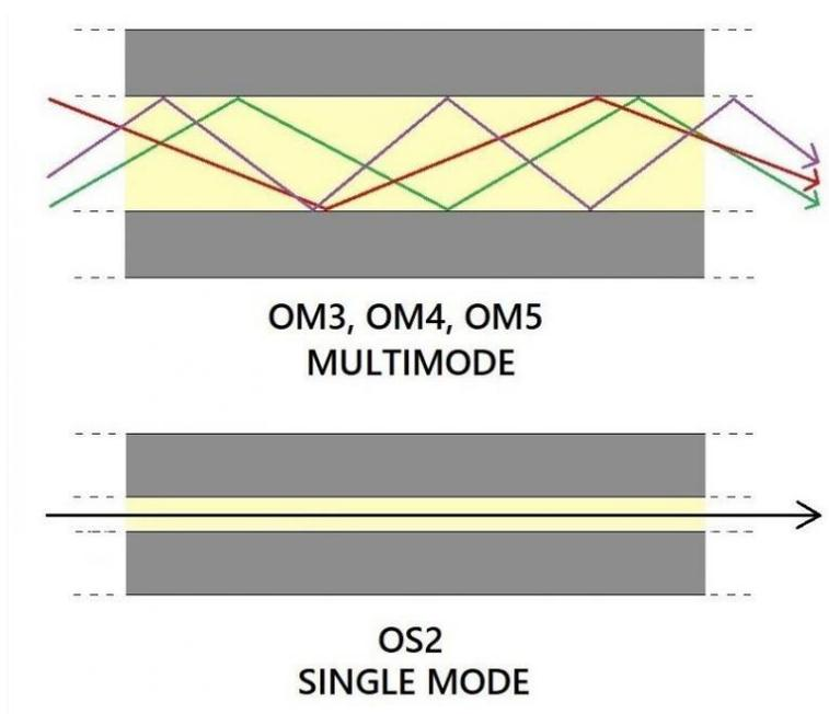
Le fibre multimodali ottimizzate per l'utilizzo con laser da 50/125  $\mu\text{m}$  (OM3 e OM4) sono state tradizionalmente raccomandate per le dorsali di edificio per 10 Gb/s fino a 300 m (OM3) e 550 m (OM4) sulla base del minor costo globale del sistema se confrontato con la soluzione monomodale (fibra e transceiver ottici). La fibra monomodale è tipicamente installata dove le lunghezze di canale sono previste superiori alle distanze massime specificate per le fibre multimodale, come,
