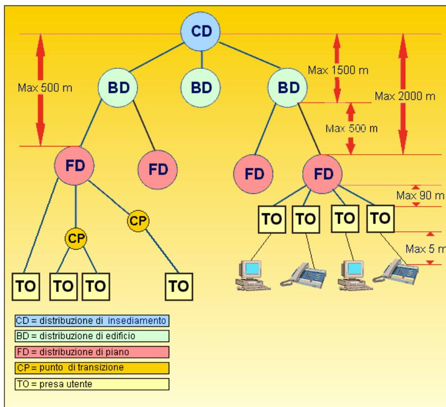
Figura 1 - Struttura e topologia del cablaggio
