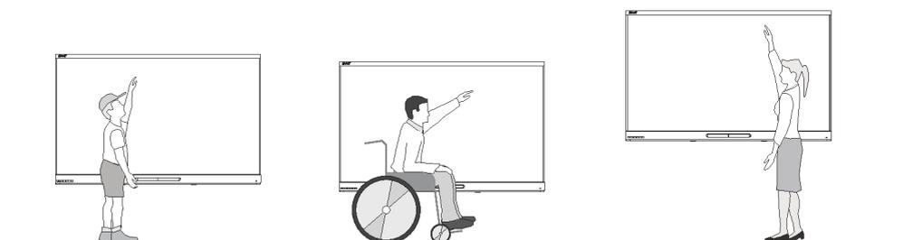
SMART consiglia di montare il display in modo che la sua parte superiore si trovi a 1,9 m (6' 5") dal pavimento.
