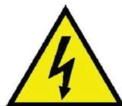
Tensione elettrica pericolosa
