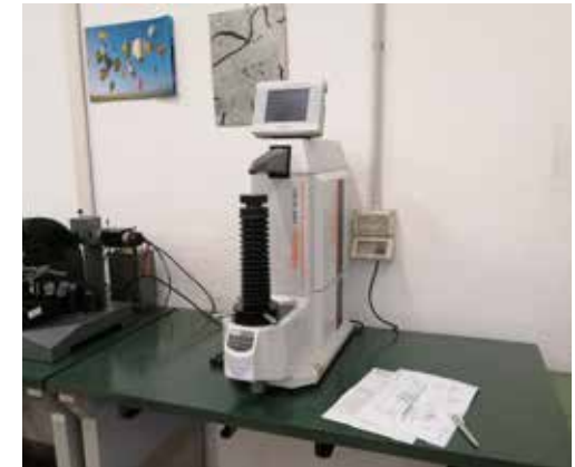
4. Il nuovo durometro presso il Lab di Tecnologia Meccanica
