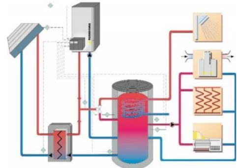
Il metodo più diffuso per generare il calore è di bruciare un combustibile fossile in una caldaia. Il calore viene usato per riscaldare l'acqua, che viene convogliata verso i locali di destinazione attraverso opportuni condotti.
